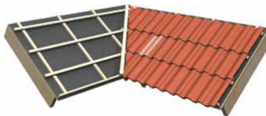
28 pav. Stoglatakių vietose naudokite ir pusines čerpes, nes pjaunant mažus gabaliukus iš pilnos čerpės, juos gana sunku pritvirtinti. Pusinė čerpė parodyta paveikslėlyje. Norimas nupjauti čerpes pažymėkite ant stogo, bet pjaukite jas pasidėję ant žemės. Iš karto po pjovimo nuplaukite čerpes po tekančiu vandeniu!
