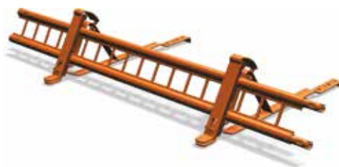
30 pav. Norint išvengti čerpių pažeidimo prie stoglatakių dėl slenkančio sniego, sumontuokite sniego „peilius“. Naudokite 3-4vnt / m 2 .
