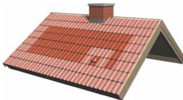
25 pav. Pritvirtinkite visas paryškintas čerpes.
