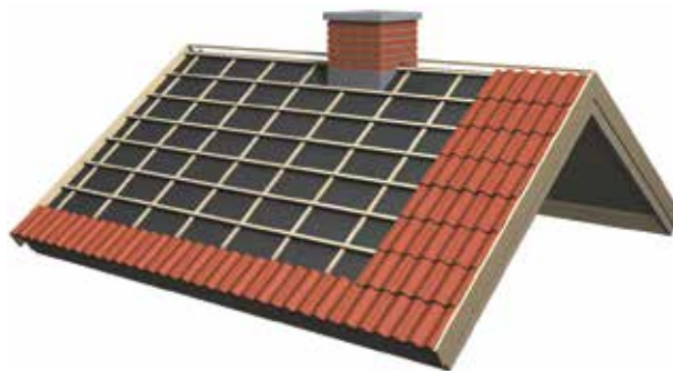
23 pav. Pradėkite kloti čerpes iš dešinės į kairę pusę, išdėliodami visą apatinę čerpių eilę (arčiausiai karnizo). Toliau iš dešinės pusės dėkite po dvi ar tris čerpes viena ant kitos link kraigo. Įsitinkite, kad eilės tiesios.
