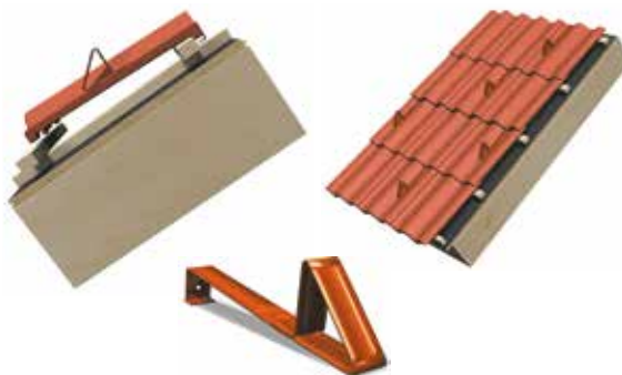
30 pav. Norint išvengti čerpių pažeidimo prie stoglatakių dėl slenkančio sniego, sumontuokite sniego „peilius“. Naudokite 3-4vnt / m 2 .
